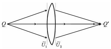
在透镜前后各取一个平面,入射波和透射波的复振幅分别为
