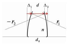
对于薄透镜,采取傍轴近似,认为镜中的光线平行于光轴。从图上可以求得 经透镜后的位相差为
