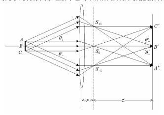
物可以看作是一系列不同空间频谱的集合。图示的相干成像分两步完成。第一步是物上的光发生夫琅和费衍射,在透镜的后焦平面上形成一系列的衍射斑。 第二步是将各个衍射斑作为新的光源,其发出的各个球面次波在像平面上进行相 干叠加,像是干涉的结果,即干涉场。这就是阿贝成像原理。
