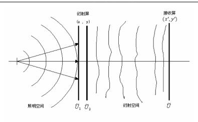
波在衍射屏的前后表面处的复振幅分别为 $ilde{U}_1(x,y)$ 和 $ilde{U}_2(x,y)$ ,接收屏上的复振幅为 $ilde{U}(x',y')$ ,分别称之为入射场、透射场(或反射场)和接收场。衍射屏
