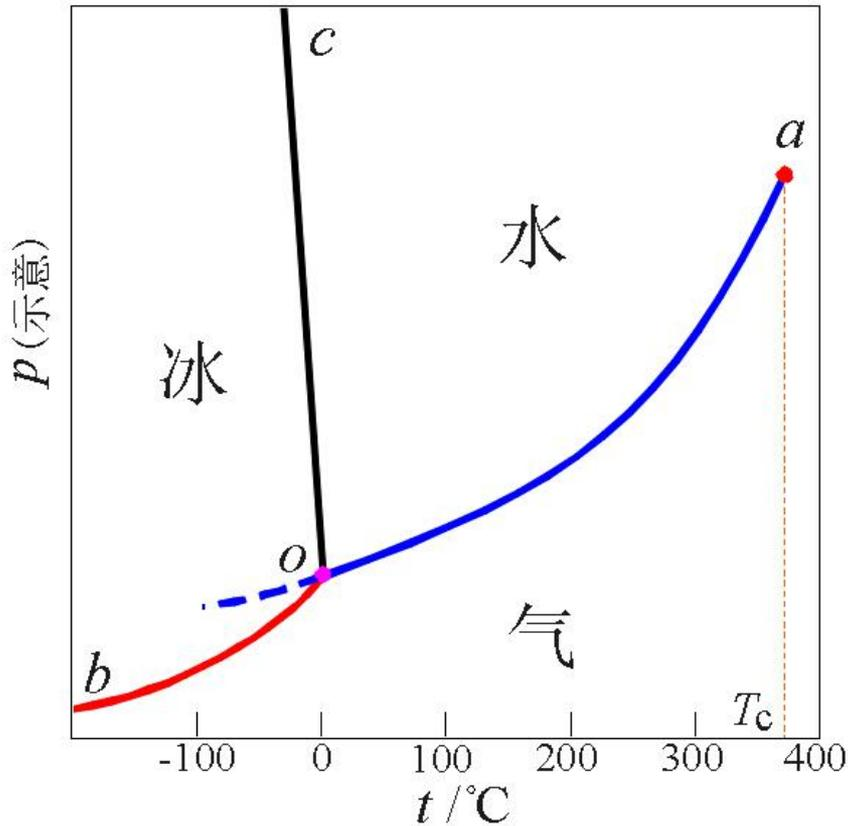
**oa**—水的气液平衡线；水的饱和蒸气压随温度的变化；水的沸点随压力的变化
